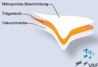
Hierbei handelt es sich um einen Membranschlauch, der im Schweißverfahren hergestellt wurde. Zusätzlich wurde ein dickes Vakuummedium auflaminiert um die Luftführung um Werkzeuge oder auf Bauteilen zu maximieren. Das hierfür verwendete Membranlaminat kann bis zu einer maximalen Temperatur von 100°C und unterschiedliche Harztypen eingesetzt werden. Da die Harz- und Härterkomponenten unterschiedlich auf die Membransysteme reagieren, empfiehlt es sich einen Kompatibilitätstest durchzuführen.
